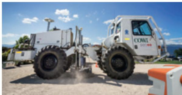
Camion vibreur et capteur «géophone» utilisés lors de la phase de prospection.
