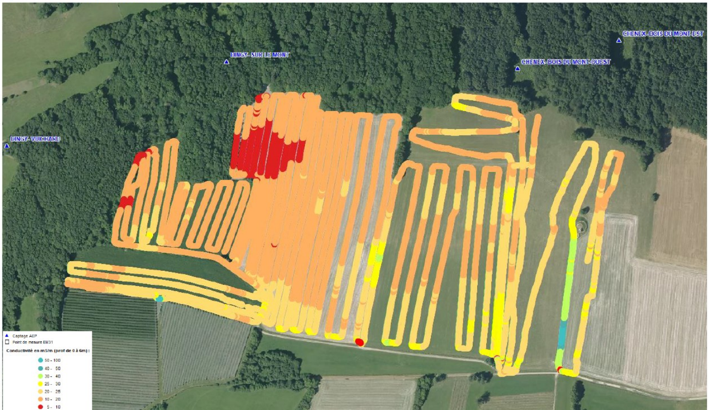
Figure 1-3 : Résultats de la prospection électromagnétique de la zone en amont du captage de sur le Mont
