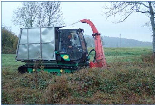
Gyrobroyeuse sur chenille adapté aux interventions en zone humide avec benne pour collecter les produits broyés
