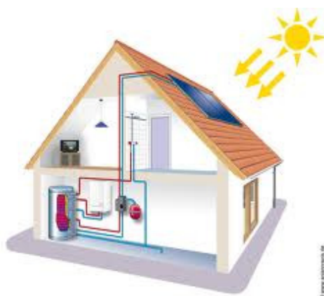
Figure 17 : Schéma de principe du fonctionnement de capteurs solaire thermique
